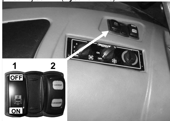
Rysunek 4-33 Przełączniki sterowania amortyzacją przedniego mostu na lewym nadkolu w kabinie ciągnika.
