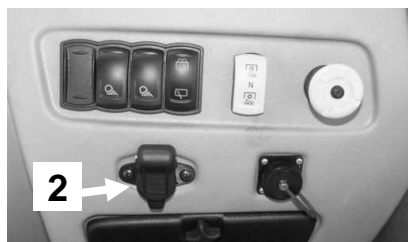
Rysunek 5-30 Złącze 1 instalacji elektrycznej dla przyczep i gniazdo 2 zasilania +12V 20A dodatkowych odbiorników dołączonych do instalacji elektrycznej ciągnika.
