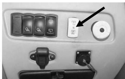
Rysunek 4-28 Przełącznik włączania odpowiedniej prędkości obrotowej WOM: 540 lub 1000 obr/min.
