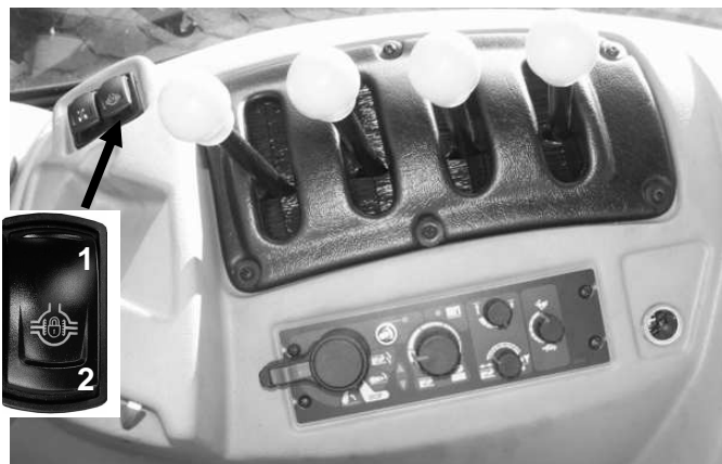
Rysunek 4-27 Sterowanie blokadą mechanizmu różnicowego przedniego mostu (znajduje się na panelu włączników z prawej strony siedziska)
