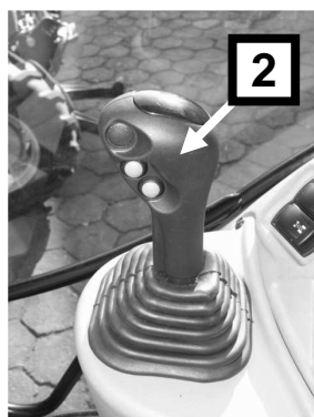
Rysunek 5-5 Dźwignia reduktora „żółw – zając”.
