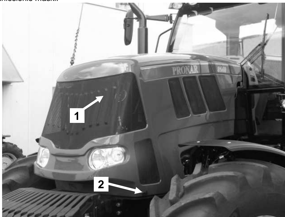
Rysunek 5-38 Maska i osłony boczne silnika. 1 - maska silnika; 2 - cięgiło zamka maski
